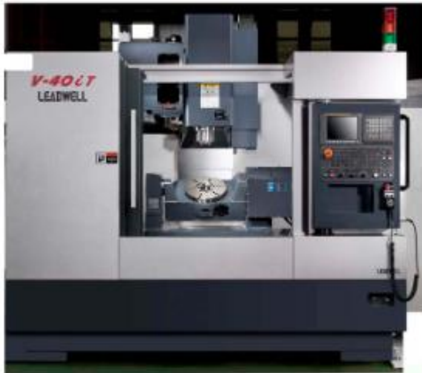
2 – Сурет. Тік фрезерлік өңдеу орталығы CNC LEADWELL V-40IT.
